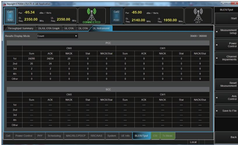
图4 LTE 仿真器记录的HARQ捕获结果显示了在扫描过程中第3次重发
