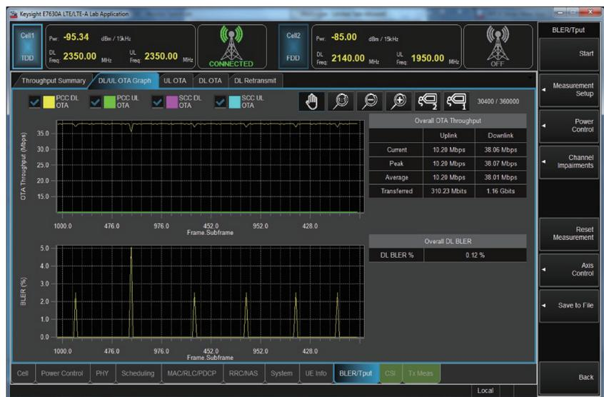
图3 定期扫描从用户设备图形用户界面触发的 WiFi 网络行动，会导致 BLER 出现明显变化
