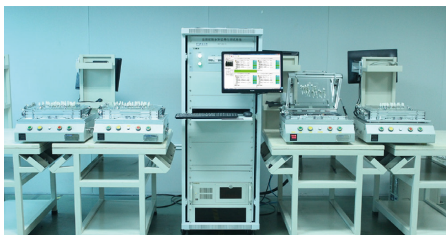
图4 聚星射频音频并行测试系统
