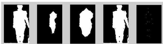
(a)去背景 (b)腐蚀 (c)膨胀 (d)肩和髋节点 (e)关节点
