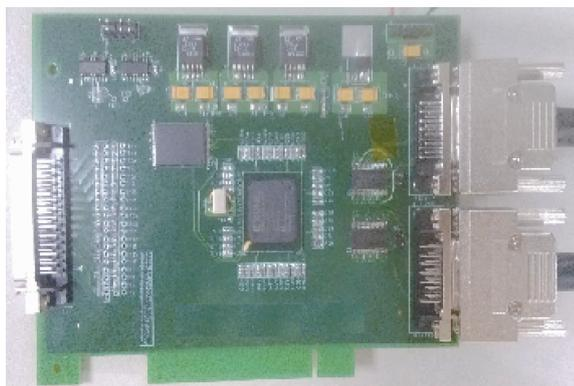
图 4 FPGA 硬件电路实物
