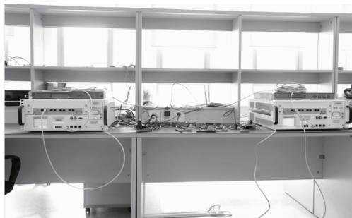
图2 ZigBee网络测试平台实物
