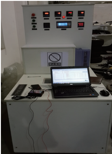
图4 TPMS测试试验台系统硬件实物
