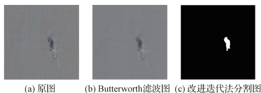
图 9 疵点分类为破洞的处理结果
