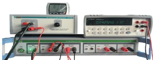
图6 双电桥热敏电阻功率计连接实物图
