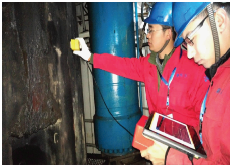
图 11 自升式钻井平台桩腿升桩室内桩腿焊缝检测
