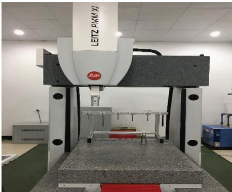
图1 三坐标测量机
