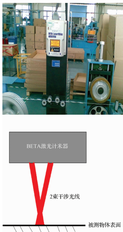
图2 计米器非接触式在线校准
