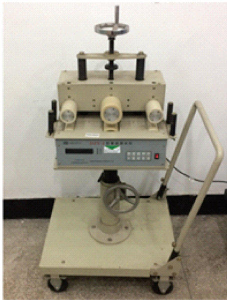
图1 计米器接触式在线校准
