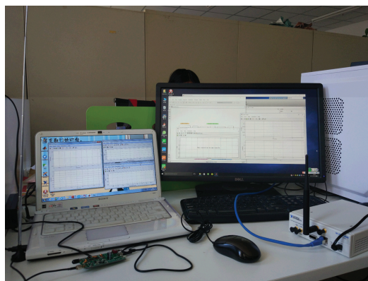
图4 基于 USRP 与 RTL-SDR 的实验平台组成
