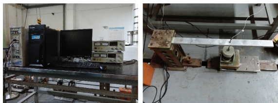
图 4 超高斯随机振动试验现场
