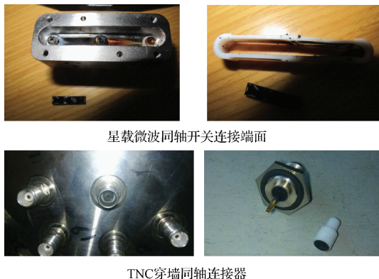
图1 微放电效应造成的损坏示意图
