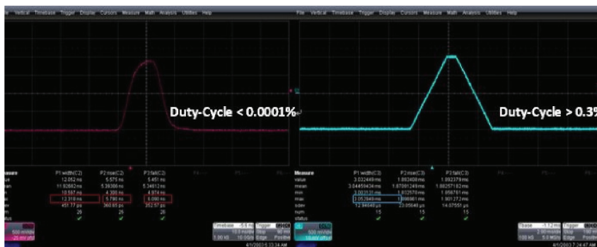
图6 EasyPulse 技术(左)和 DDS 技术(右)的占空比极限对比
