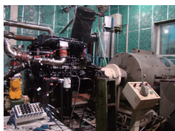
(a) 基于cDAQ平台的应力测试
