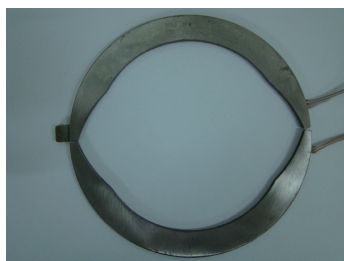
(a) 止推片温度测点 (b) 止推片K型热电偶传感器 图8 发动机止推片温度传感器
