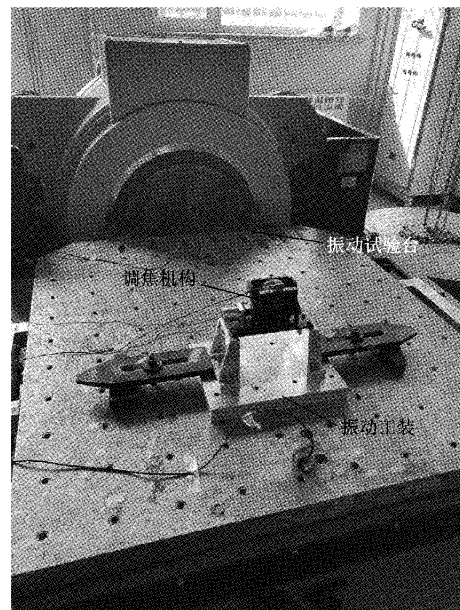
图12 调焦机构的振动试验
