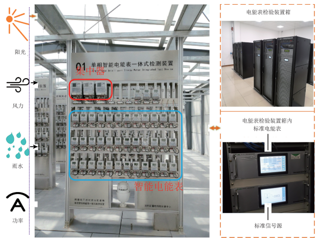
图 4 新疆智能电能表现场运行试验
