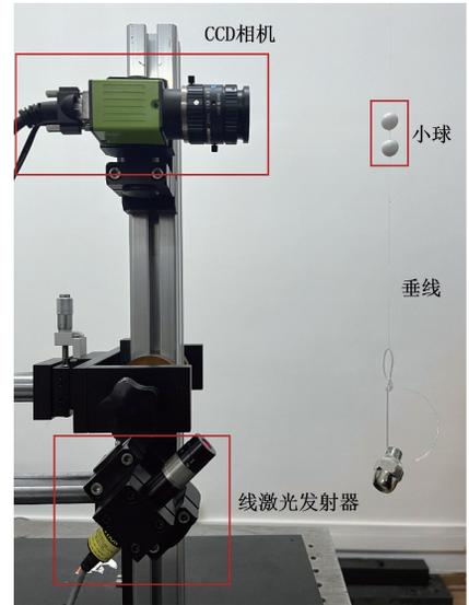
图 6 测量装置结构图
