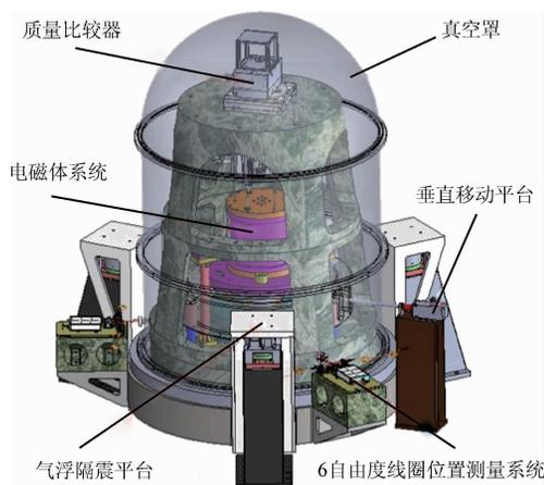
图5 第2代能量天平装置示意图
