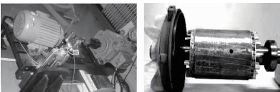
图2 电机实验台和实验用故障转子示例
