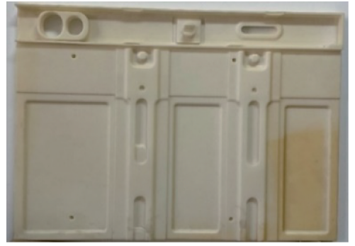
图9 电动汽车电池包3D打印模型
