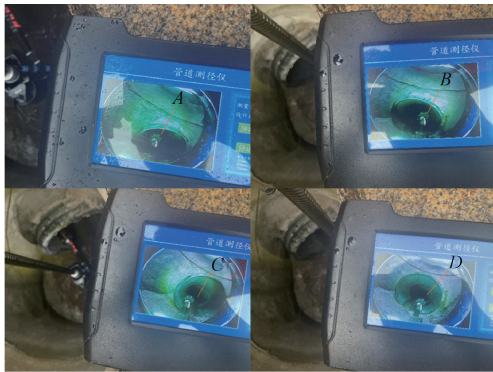
图 17 实际环境管径的横截面分区示意图
