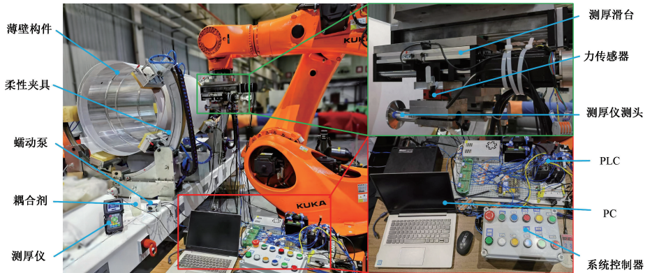
图 11 大型薄壁构件加工误差补偿现场
