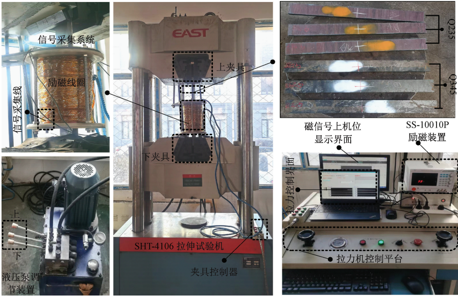
图 11 整体拉伸试验平台搭建
