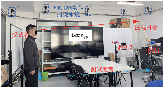
图 8 真实场景下的双视角测量系统配置图
