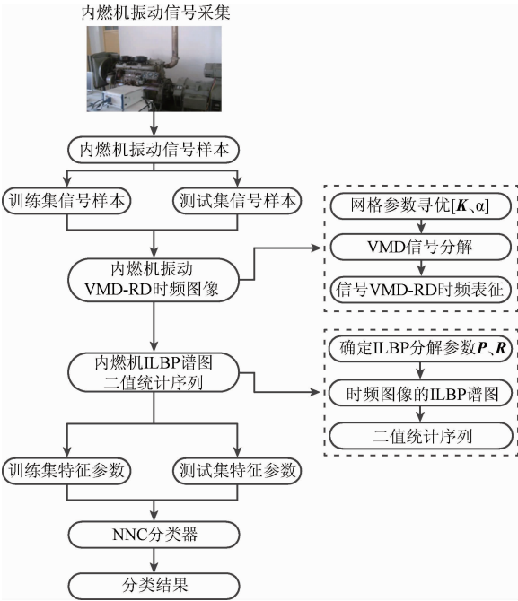
图 5 故障诊断实验流程 Fig. 5 Flowchart of fault diagnosis
